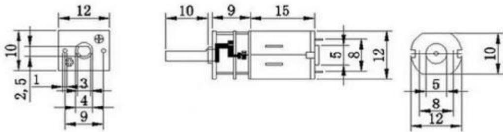
图2 电动机尺寸参数（供参考，单位：mm）
